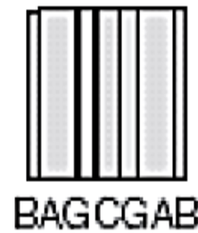
7-kerroksinen koekstuusiolla valmistettu rakenne
