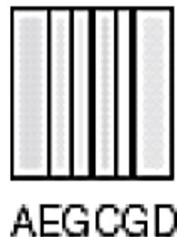
6-kerroksinen koekstuusiolla valmistettu rakenne
