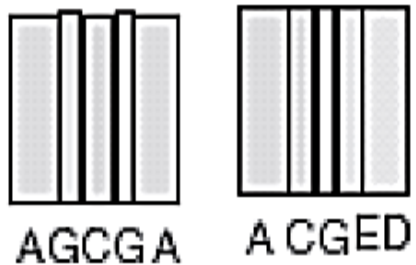
5-kerroksinen koekstuusiolla valmistettu rakenne
