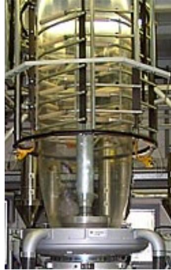
Las burbujas generalmente se estabilizan externamente usando dispositivos como una **JAULA**, para evitar el movimiento de la burbuja que resultará en espesores de pared no uniformes
